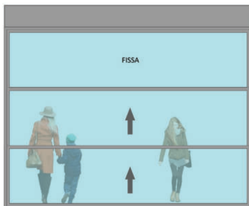
SALISCENDI MOTORIZZATO A TRE ANTE: DUE ANTE MOBILI E UNA FISSA (FACCIATA CONTINUA CON APERTURA INFERIORE PER IL PASSAGGIO)
