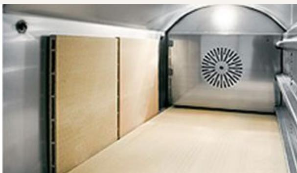
**Camera di cottura a volta rotonda con piastre in refrattario:** a differenza di altri prodotti in commercio, il design interno del vano cottura a volta rotonda favorisce la diffusione uniforme del calore: in questo modo le pietanze vengono cotte in modo omogeneo.
